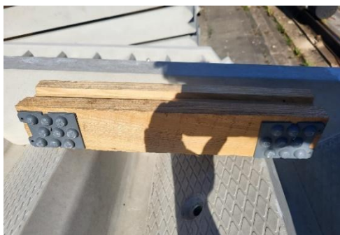
Positie onderstoppingshout tijdens transport
